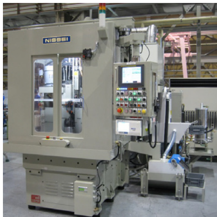
砂轮轴1: 磨削 砂轮轴2: 超精磨
