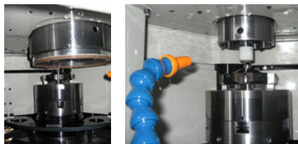
砂轮轴1: 磨削 砂轮轴2: 超精磨
